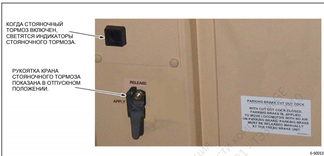
Рис. 19. Кран стояночного тормоза со световой индикацией.
