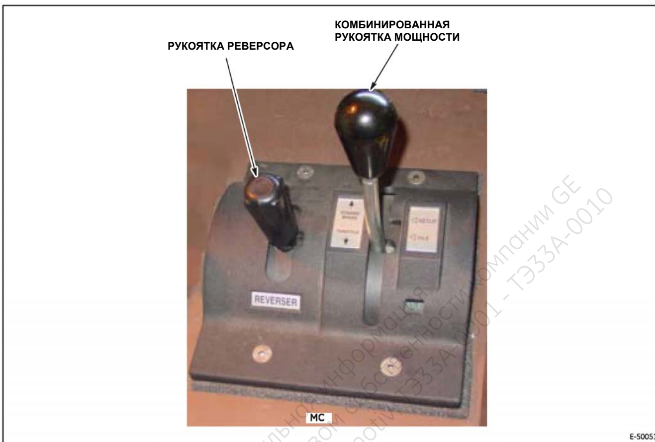
Рис. 9. Главный контроллер (MC).
