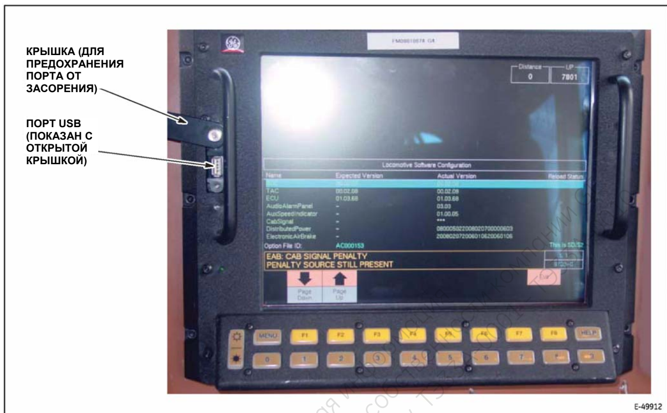
Рис. 5. Типичный экран программируемого дисплея SDIS и функциональные клавиши.
