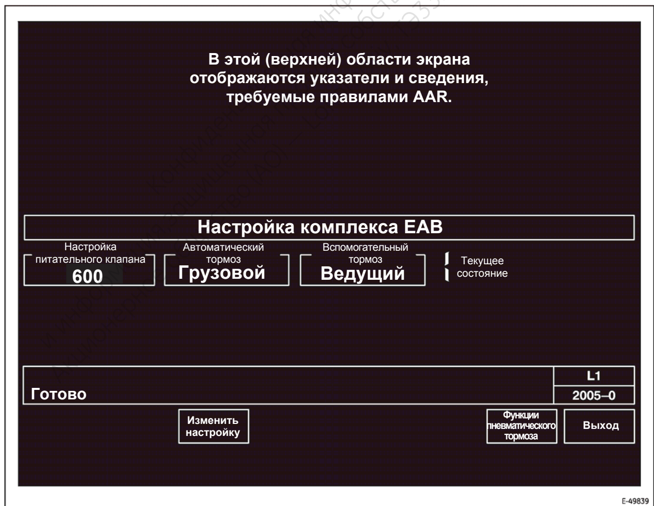
Рис. 48. Окно настройки комплекса EAB (2005–0).
