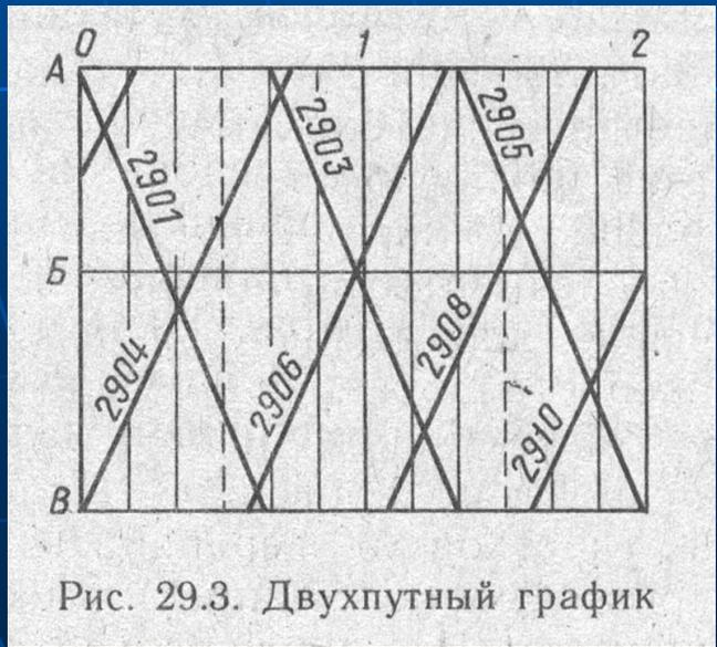
Рис. 29.3. Двухпутный график
