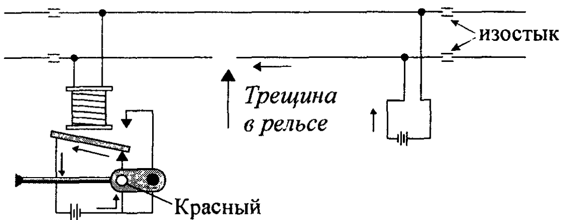
Рис. 49а Рельсовая цепь из за трещины в рельсе незамкнута (катушка не получает питание, светофор закрыт)
