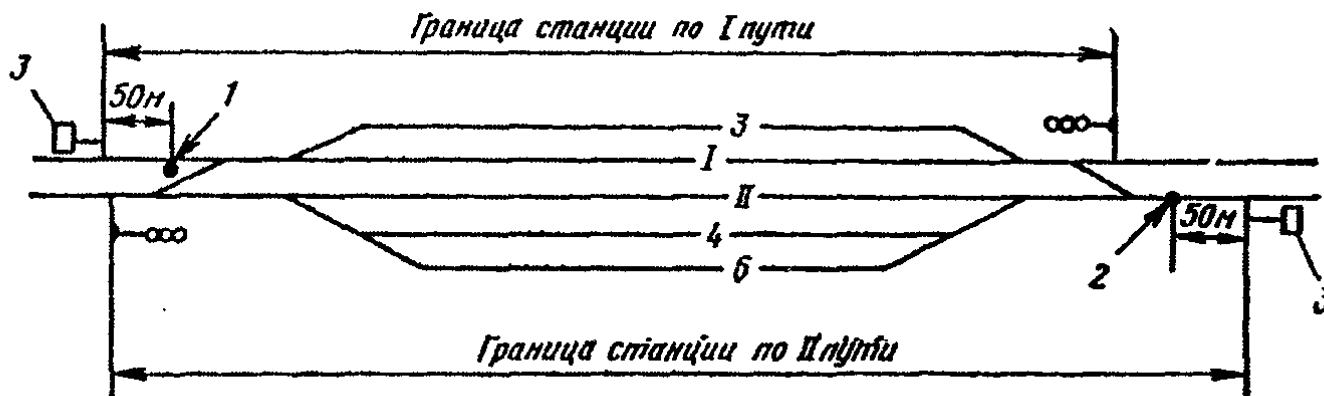
Рис. 72 Границы станции на однопутном участке
