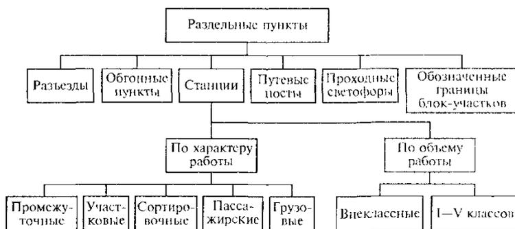
**Разъезд** – раздельный пункт на однопутных железнодорожных линиях, имеющий путевое развитие, предназначенное для скрещения и обгона поездов.
