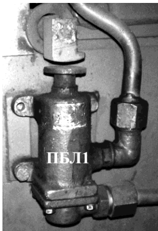
Рис. 286. Положение блокировки ПБЛ1 при разблокированной ВВК и заблокированной ВВК и блокировка люка выхода на крышу
