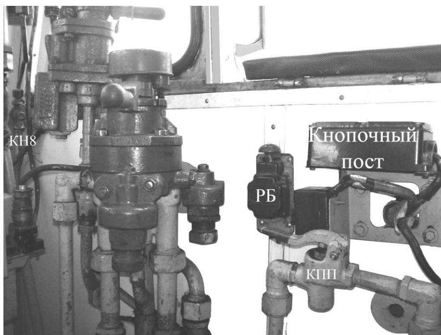
Рис.139. Расположение оборудования вдоль боковой стенки кабины со стороны машиниста
