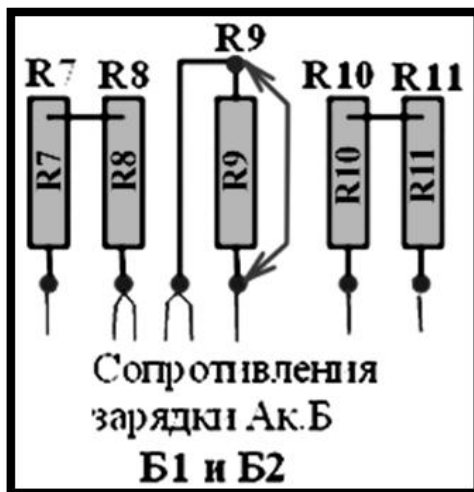
Рис. 281. Соединение сопротивлений для шунтирования контакта контактора К1
