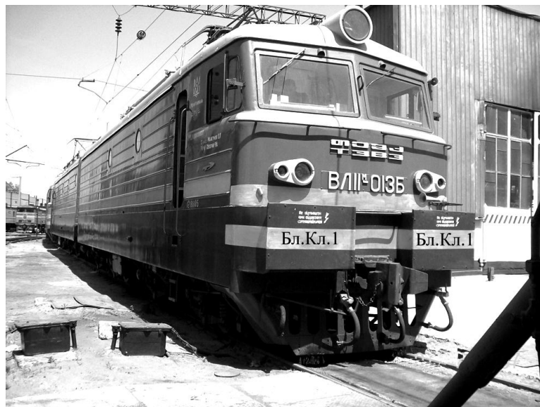
Рис. 321. Внешний вид электровоза ВЛ11м с обозначением расположения блока клемм Бл.Кл.1
