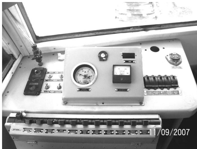
Рис. 137. Пульт управления со стороны помощника машиниста в кабине электровоза
