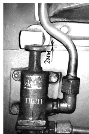
Рис. 244. Вентиль защиты Кп.Зщ.13 и блокировка ВВК - ПБЛ1
