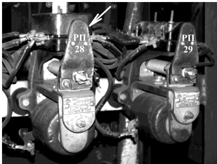
Рис. 307. Подклинивание РП28 во включенном положении
