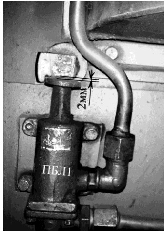
Рис. 286. Положение блокировки ПБЛ1 при разблокированной ВВК и заблокированной ВВК и блокировка люка выхода на крышу
