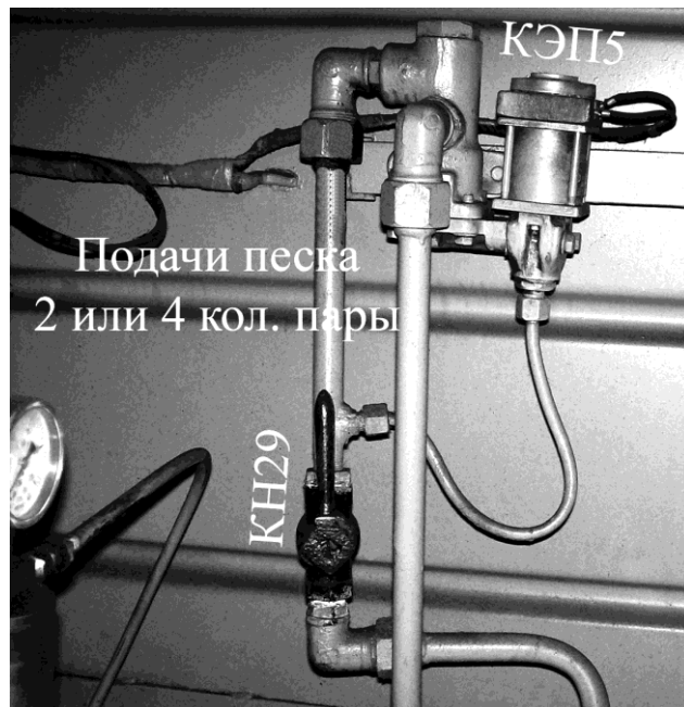
Рис. 251. Вентиль КЭП5 подачу песка под 2 ю или 4 ю колесные пары и разобщительный кран КН33
