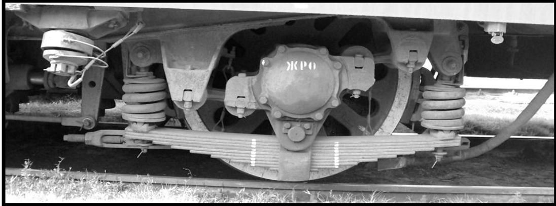
Рис. 327. Буксовый узел и рессорное подвешивание колёсной пары
