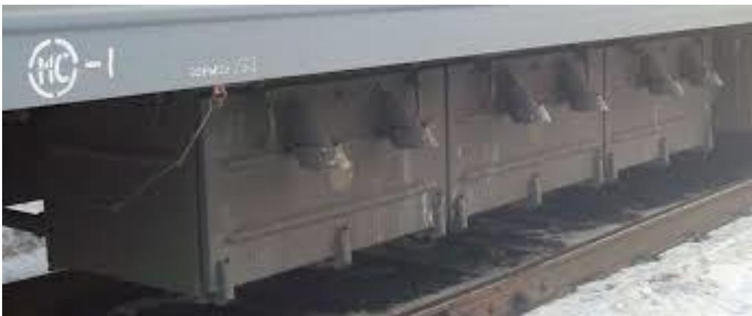
**Аккумулятором** называется химический источник тока, который способен накапливать и сохранять электроэнергию, полученную от подвагонного генератора или от подзарядного устройства, а затем отдавать её.
